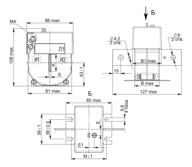
Рис.1.Общий вид трансформаторов тока ТОП-0,66
