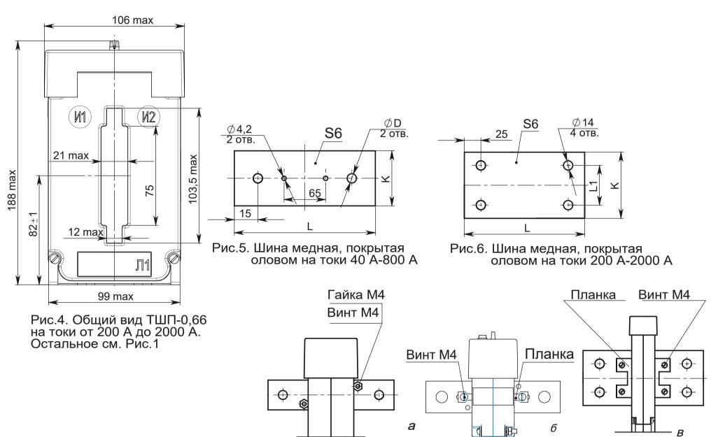
Рис.7 - крепление шины в окне трансформатора
